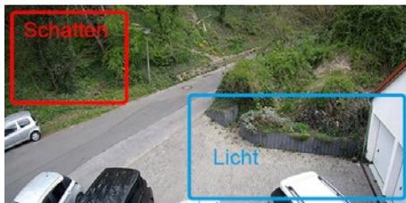
Details sowohl in dunklen als auch in hellen Bildbereichen kommen besser zur Geltung. Dadurch, dass die einzelnen Objektbereiche in einer Szene von der Kamera unterschiedlich belichtet werden, sind die Objekte in den hellen sowie in den dunklen Bereichen sichtbar.
